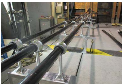
Essais électrodynamique des colliers SL
