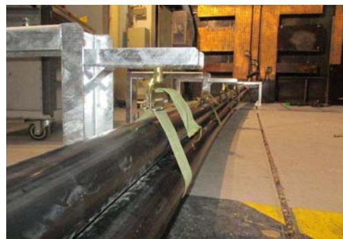
Essais électrodynamique des colliers à sangle
