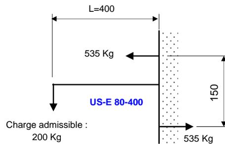
Exemple de montage avec FBN 80 complet plaque de serrage tige filetée et écrou HM 12
