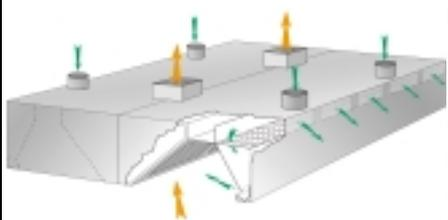
Ensemble en acier **inox 18/10** finition "**Grade 220**", sauf tôles supérieures en acier galvanisé. **FILTRES A CHOC 450 x 450 x 17 / 50** mm, tout inox.
