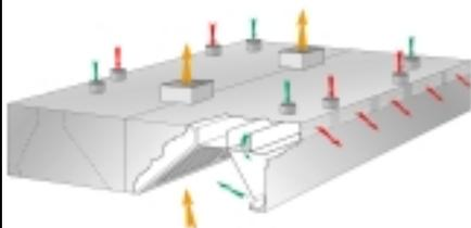
Ensemble en acier **inox 18/10** finition "**Grade 220**", sauf tôles supérieures en acier galvanisé. **FILTRES A CHOC 450 x 450 x 17 / 50** mm, tout inox.
