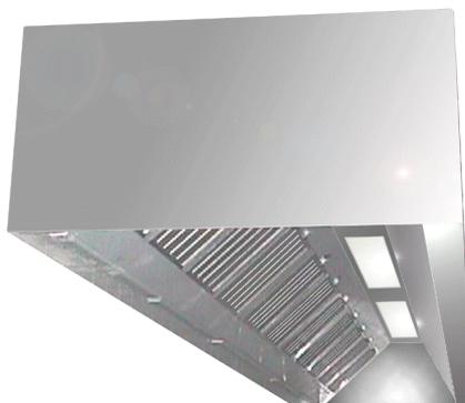
Ensemble en acier **inox 18/10** finition "**Grade 220**", sauf tôles arrières et supérieures en acier galvanisé. **FILTRES A CHOC 450 x 450 x 17 / 50 mm**, tout inox. Les hottes à induction sont composées d'une partie d'extraction d'air munie de filtres et d'un ensemble de soufflage assurant la **compensation** de l'air extrait dans une proportion réglable de 50 à 70 %. Ce principe **diminue fortement** les mouvements d'air dans la cuisine.
